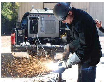
Manuelles Schneiden im Außeneinsatz
